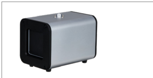
JQ-D70Z - Caja de referencia de temperatura Sensor de cuerpo negro (Blackbody) / Temperatura de trabajo de 5 a 40° / Superficie radiante 70mm x 70mm / Precisión de temperatura \pm 2^\circ .
