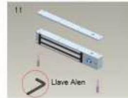
11 Utilice una llave Allen para atornillar el cuerpo de la cerradura en la placa de montaje.
