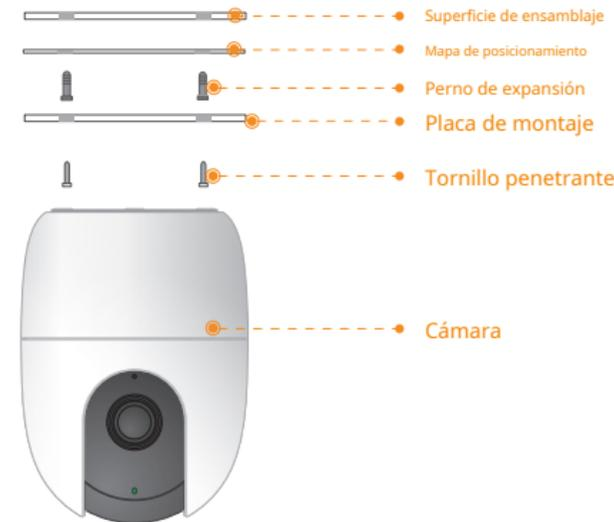
**Paso 1** Taladre orificios para tornillos en la superficie de montaje como el mapa de montaje muestra, y luego coloque los pernos de expansión.
