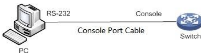
Figura 4-1 Conexión con cable de puerto de consola
